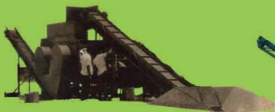
เครื่องสับมันเส้น (ติดตั้งบนพื้น)
